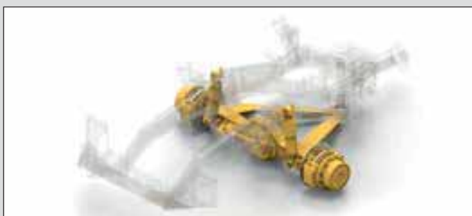
Для повышения производительности амортизатор передней подвески позволяет сократить вибрацию, а верхнее сидение с подвеской снижает крен, часто возникающий во внедорожных условиях.
